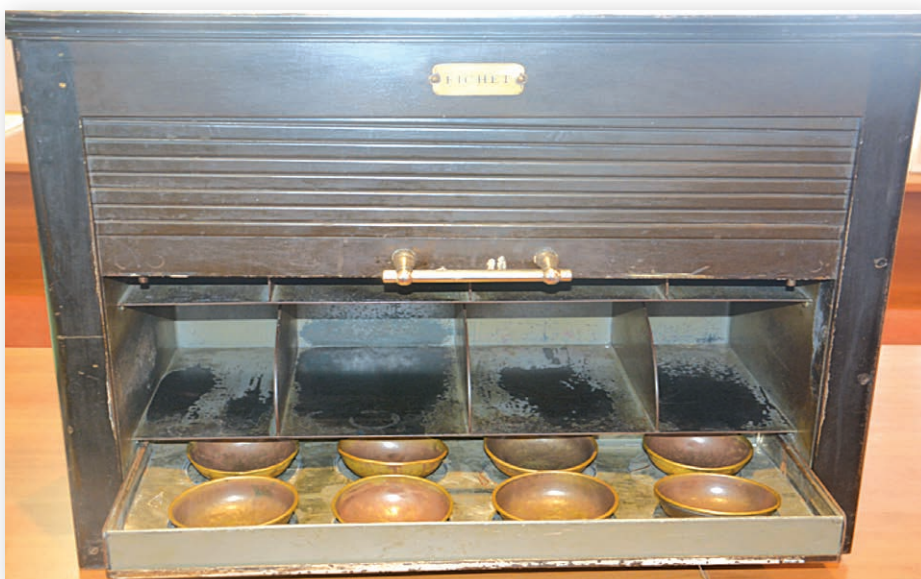
Ancien coffre-payeur de marque «FICHET» avec rideau de fermeture, servant à la manipulation des pièces de monnaie et des billets de banque. (Musée de la Trésorerie Générale du Royaume)
